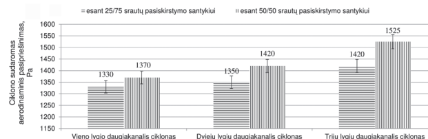
5 pav. Vieno, dviejų ir trijų lygių aštuonių kanalų ciklono aerodinaminis pasipriešinimas, panaudojant cilindrinis ketvirtžiedžius su 5° kampu atlenktomis angų plokštelėmis, esant 25/75 ir 50/50 srautų pasiskirstymų santykiui ir 16 m/s vidutiniam oro srauto greičiui ciklono kanaluose
