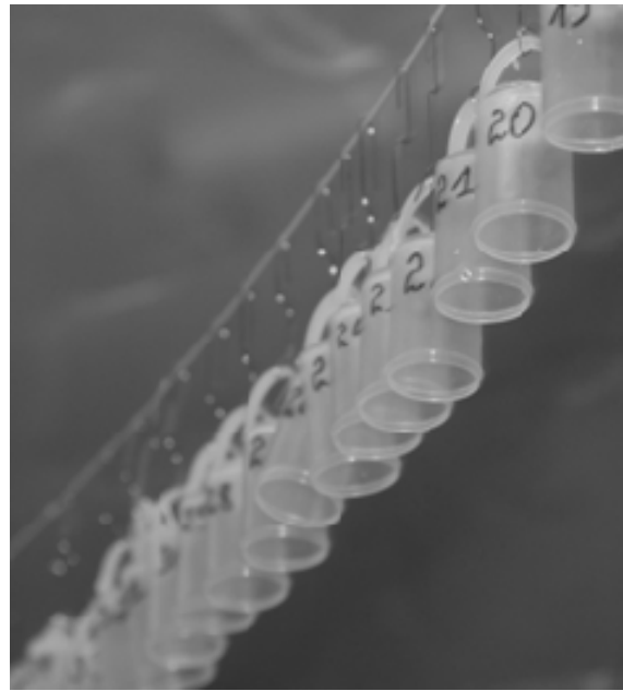
3 pav. Difuziniai kaupikliai, pakabinti eksperimentinėje kameroje
